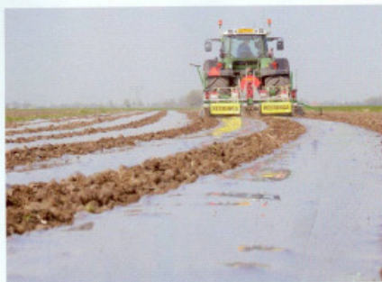
De Samco-zaaimachine zorgt in één werkgang voor maisinzaai, bespuiting, het aanbrengen van de laag plastic en het aanmaiden. FOTO: PINK COMMUNICATIE
